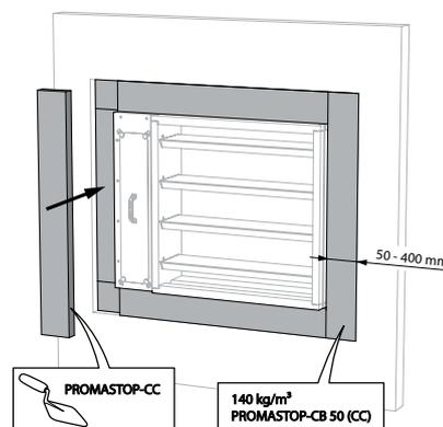
4. Colmatez le reste de la réservation à l'aide de 2 couches de panneaux de laine minérale pré-enduits de 50 mm d'épaisseur (type PROMASTOP CB-CC). Les panneaux doivent être posés à joints décalés. Lors de l'installation, appliquez toujours un enduit (type PROMASTOP CC) à l'extrémité de chaque panneau.
