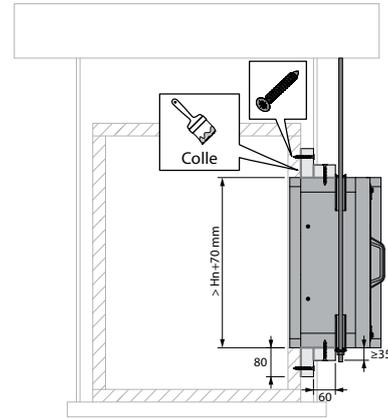
4. Scellez le joint entre le volet et la réservation avec de la Promat Glue K84. Installez les plaques de positionnement et de scellement avec des vis  $\varnothing 5 \times 50$  mm avec un espacement maximum de 200 mm et de la Promat Glue K84. Veillez à ce qu'aucune vis ne pénètre dans le boîtier du clapet.
