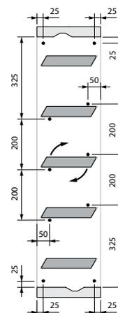
2. Fixez un volet à l'autre avec les vis fournies  $\varnothing 5 \times 70$  mm. Faites attention au sens de rotation des lames et assurez-vous que les vis n'interfèrent pas avec les lames.
