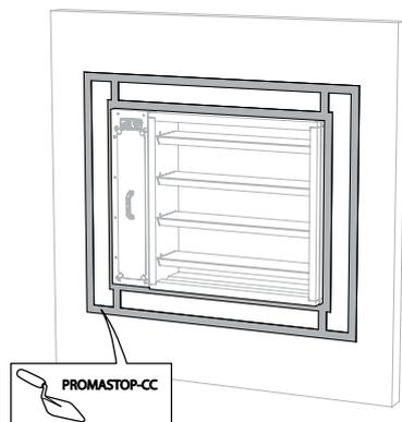
5. Les panneaux doivent être posés à joints décalés et ces joints sont recouverts sur tout le contour (type PROMASTOP-CC), afin de créer une épaisseur de couche uniforme pour l'ensemble du scellement.
