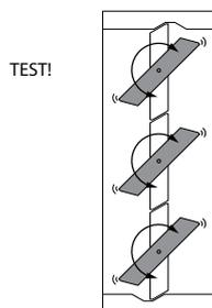
5. Vérifiez le fonctionnement des lames du volet après le temps de durcissement de la scellement et après avoir retiré les entretoises. Soumettez le mécanisme du clapet/volet à un test.
