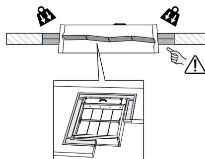
6. Soutenez le tunnel et serrez les lames dans sa position de sécurité pour éviter la déformation du tunnel lors du dessèchement du colmatage.
