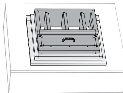
2. Le volet peut également être directement intégré dans la paroi. Installez le volet dans la réservation avec la trappe d'accès accessible. Placez la paroi arrière du volet contre le conduit. L'installation du volet ne requiert pas de profondeur minimale de conduit. Le produit n'entravera pas le débit d'air dans le conduit.
