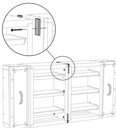
1. Pour un montage en batterie avec les lames alignées entre elles :
