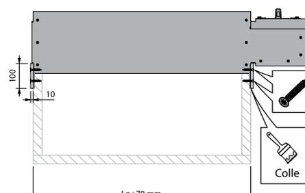
4. Pour le scellement à plat sur la bride du volet, utilisez une plaque de silicate de calcium de 10 x 100 mm d'une densité de 870 kg/m<sup>3</sup> (type PROMATECT H). Fixez ces plaques avec deux rangées de vis Ø 3,9 x 35 mm écartées de 150 mm.
