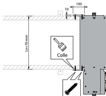
2. Scellez le joint entre le volet et la réservation avec de la Promat Glue K84. Pour le scellement à plat sur la bride du volet, utilisez une plaque de silicate de calcium de 10 x 100 mm d'une densité de 870 kg/m<sup>3</sup> (type PROMATECT H). Fixez ces plaques avec deux rangées de vis Ø 3,9 x 35 mm écartées de 150 mm.
