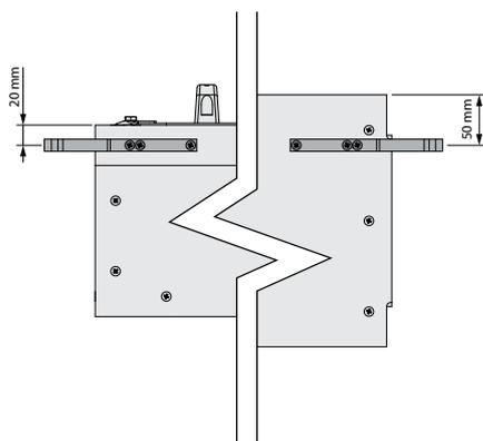
3. Fixez les équerres avec les vis fournies  $\varnothing 5 \times 35$  mm. Les vis près du compartiment de raccordement sont à 20 mm du bord, tandis que les vis dans la paroi du tunnel sont à 50 mm du bord.
