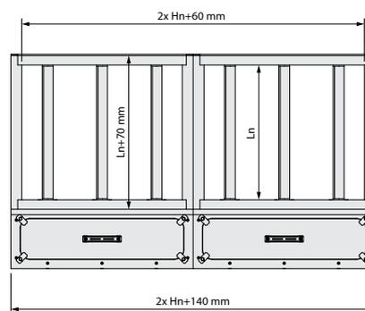
6. Le collier aux dimensions extérieures (( $2 \times W_n$ ) +140) mm x ( $H_n + 70$ ) mm convient au raccordement à un conduit ordinaire.
