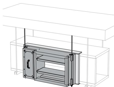
2. En option, le volet peut être suspendu séparément avec la suspension verticale (VS MAS).
