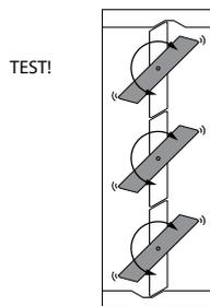
5. Vérifiez le fonctionnement des lames du volet après le temps de durcissement de la scellement et après avoir retiré les entretoises. Soumettez le mécanisme du clapet/volet à un test.
