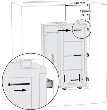
5. Forez préalablement tant dans la paroi du tunnel que dans les éléments du KITS SUPP pour le placement d'un ancrage supplémentaire. Veillez toujours à ce que le jeu entre la paroi du tunnel et l'ébrasement soit entièrement supprimé par les éléments du KITS SUPP.
