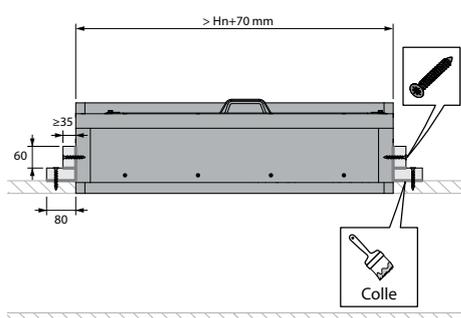
3. Scellez le joint entre le volet et la réservation avec de la Promat Glue K84. Installez les plaques de positionnement et de scellement avec des vis Ø 5 x 50 mm avec un espacement maximum de 200 mm et de la Promat Glue K84. Veillez à ce qu'aucune vis ne pénètre dans le boîtier du clapet.
