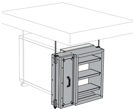
1. Placez le volet au milieu du conduit avec des dimensions extérieures  $(W_n + 70) \times (H_n + 70)$  mm. Le volet peut être suspendu séparément avec la suspension verticale (VS MAS). De même, la suspension horizontale (HS MAS) peut être utilisée avec un conduit vertical.
