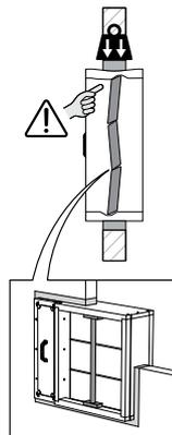
7. Soutenez le tunnel et serrez les lames dans sa position de sécurité pour éviter la déformation du tunnel lors du dessèchement du colmatage.
