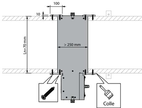
3. Scellez le joint entre le volet et la réservation avec de la Promat Glue K84. Pour le scellement à plat sur la bride du volet, utilisez une plaque de silicate de calcium de 10 x 100 mm d'une densité de 870 kg/m<sup>3</sup> (type PROMATECT H). Fixez ces plaques avec deux rangées de vis Ø 3,9 x 35 mm écartées de 150 mm.
