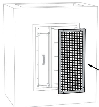
10. Parachevez l'installation. Placez une grille, afin d'éviter tout contact direct avec les volets du clapet.
