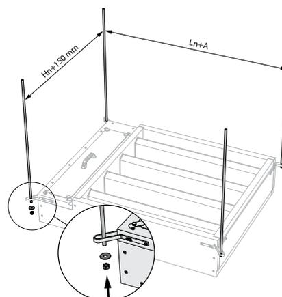
4. Fixez les équerres avec les vis fournies  $\varnothing 5 \times 35$  mm. Les vis près du compartiment de raccordement sont à 20 mm du bord, tandis que les vis dans la paroi du tunnel sont à 50 mm du bord. Montez les tiges filetées ( $\geq M10$ ) pour la des volets, avec  $A = 375$  mm pour un volet standard.
