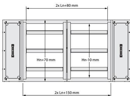
3. Le collier aux dimensions extérieures ((2 x Wn) +150) mm x (Hn + 70) mm convient au raccordement à un conduit ordinaire.
