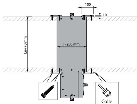
2. Scellez le joint entre le volet et la réservation avec de la Promat Glue K84. Pour le scellement à plat sur la bride du volet, utilisez une plaque de silicate de calcium de  $10 \times 100$  mm d'une densité de  $870 \text{ kg/m}^3$  (type PROMATECT H). Fixez ces plaques avec deux rangées de vis  $\text{Ø } 3,9 \times 35$  mm écartées de 150 mm.
