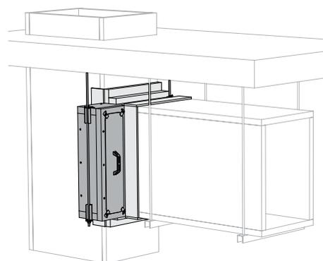
2. En option, le volet peut être suspendu séparément avec la suspension verticale (VS MAS).
