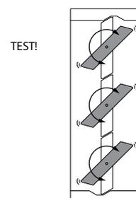
4. Vérifiez le fonctionnement des lames du volet après le temps de durcissement de la scellement et après avoir retiré les entretoises. Soumettez le mécanisme du clapet/volet à un test.
