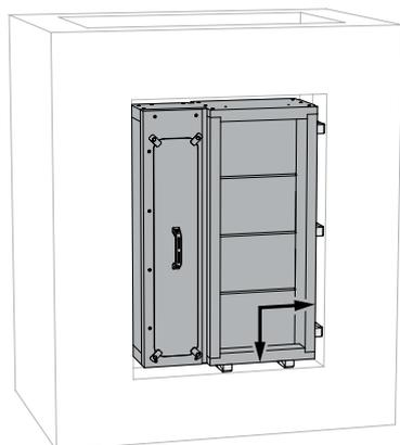
3. Placez le clapet dans l'ouverture. Raccordez le clapet avec les éléments du KITS SUPP, s'il y a lieu.
