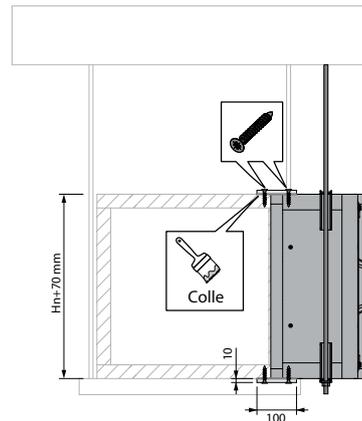
4. Pour le scellement à plat sur la bride du volet, utilisez une plaque de silicate de calcium de  $10 \times 100$  mm d'une densité de  $870 \text{ kg/m}^3$  (type PROMATECT H). Fixez ces plaques avec deux rangées de vis  $\varnothing 3,9 \times 35$  mm écartées de 150 mm.
