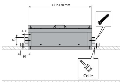
3. Scellez le joint entre le volet et la réservation avec de la Promat Glue K84. Installez les plaques de positionnement et de scellement avec des vis Ø 5 x 50 mm avec un espacement maximum de 200 mm et de la Promat Glue K84. Veillez à ce qu'aucune vis ne pénètre dans le boîtier du clapet. Fabriquez les plaques de positionnement et de scellement à partir du matériau des conduits. Pour un scellement d'angle, utilisez deux plaques de 80 mm et 60 mm respectivement.
