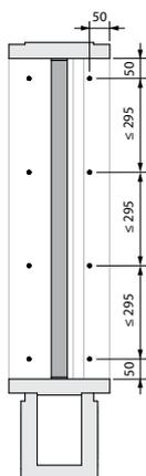
5. Fixez un volet à l'autre avec les vis fournies  $\varnothing 5 \times 70$  mm à l'avant et à l'arrière des volets.
