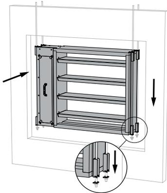
7. Placez le volet sur les languettes. Les tiges filetées doivent se trouver à l'intérieur des profils en U des équerres. Veillez à bien fixer les languettes aux équerres inférieures. Lors du passage à travers la paroi du compartiment, la suspension ne doit pas être isolée. Lorsqu'elle est installée dans des gaines, la suspension doit être isolée de manière équivalente à la suspension de la gaine.
