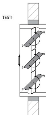
9. Vérifiez le fonctionnement des lames du volet après le temps de durcissement de la scellement et après avoir retiré les entretoises. Soumettez le mécanisme du clapet/volet à un test.
