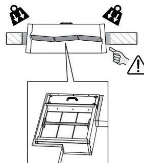
4. Soutenez le tunnel et serrez les lames dans sa position de sécurité pour éviter la déformation du tunnel lors du dessèchement du colmatage.
