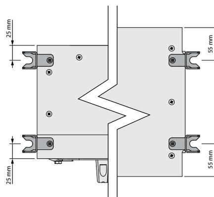
4. Fixez les équerres avec les vis fournies  $\varnothing 5 \times 35$  mm. Les vis près du compartiment de raccordement sont à 25 mm du bord, tandis que les vis dans la paroi du tunnel sont à 55 mm du bord.
