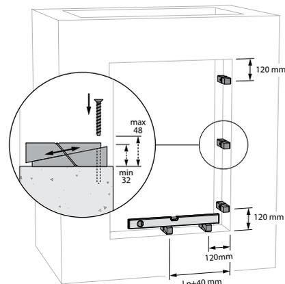
2. Le clapet peut être placé au milieu de l'ouverture à l'aide du KITS SUPP (facultatif).
