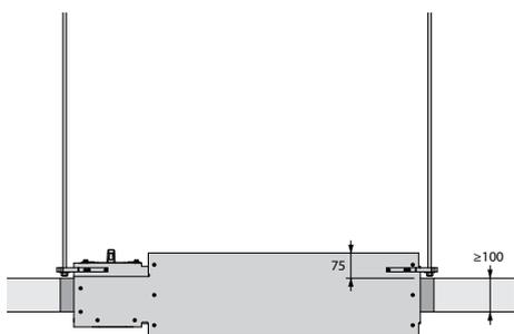
3. En option, le volet peut être suspendu séparément avec la suspension horizontale (HS MAS).
