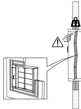
8. Soutenez le tunnel et serrez les lames dans sa position de sécurité pour éviter la déformation du tunnel lors du dessèchement du colmatage. Achevez le scellement du volet selon les directives par type de mur.
