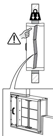
3. Soutenez le tunnel et serrez les lames dans sa position de sécurité pour éviter la déformation du tunnel lors du dessèchement du colmatage.
