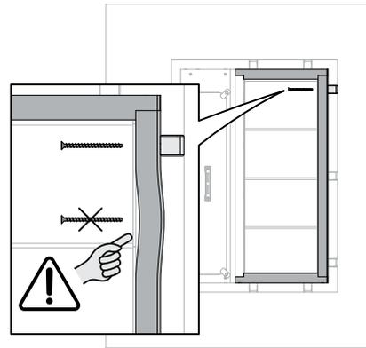
⚠ 6. Attention : la fixation du clapet sans KITS SUPP peut sérieusement endommager le produit. La paroi du tunnel peut se déformer et se rompre lors du serrage des vis d'ancrage sans soutien au niveau du joint.
