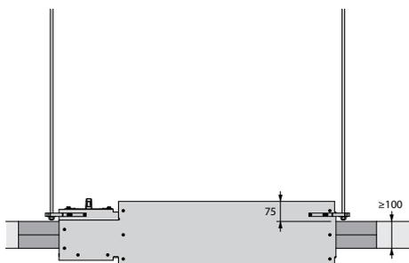
5. En option, le volet peut être suspendu séparément avec la suspension horizontale (HS MAS).
