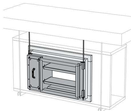
2. En option, le volet peut être suspendu séparément avec la suspension verticale (VS MAS).
