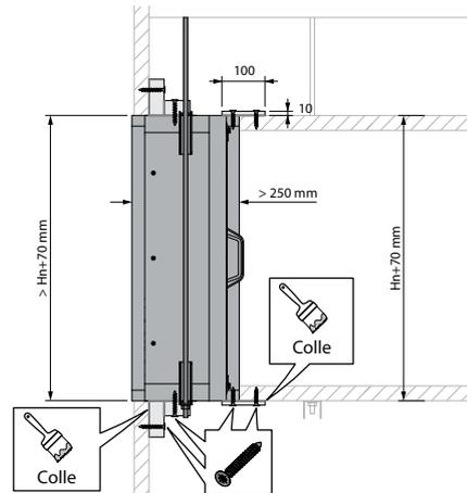
4. Installez les plaques de positionnement et de scellement avec des vis Ø 5 x 50 mm avec un espacement maximum de 200 mm et de la Promat Glue K84. Veillez à ce qu'aucune vis ne pénètre dans le boîtier du clapet. Fabriquez les plaques de positionnement et de scellement à partir du matériau des conduits. Pour un scellement d'angle, utilisez deux plaques de 80 mm et 60 mm respectivement.
